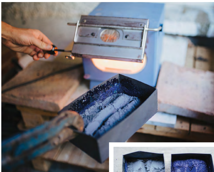
Smalteproduktion: Eine Mischung aus Kobaltsalzen mit einem Glasversatz wird in den ca. 1150°C heißen Ofen gegeben.
