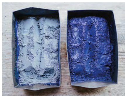
Beim Brennvorgang geht die pulverisierte Glasmasse in der Form wie ein Kuchen auf.
